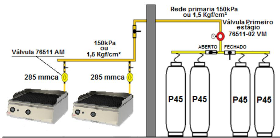
Para o funcionamento perfeito deve ser usado uma válvula de baixa pressão, ou estágio único, e no mínimo 2 botijões tipo P45. Dinâmica da montagem da válvula.
