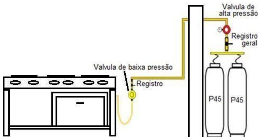
Para o funcionamento perfeito deve ser usada uma válvula de baixa pressão, ou estágio único, e no mínimo 2 botijões tipo P45. Dinâmica da montagem da válvula.
