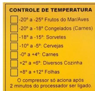
Os refrigeradores saem de fábrica com a temperatura travada em um limite mínimo e máximo, não sendo possível o usuário colocar uma temperatura fora da faixa demarcada na etiqueta amarela acima. (Exceto freezers dupla ação).
