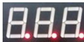
3 pontos piscando = em aquecimento, resistência ligada
