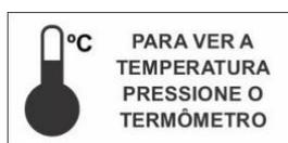
Tecla nº 6 Quando pressionada esta tecla exibe a temperatura real e instantânea do fluido de fritura no display de 3 dígitos.
