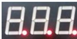
Quando a fritadeira está em aquecimento (com as resistências ligadas) os 3 pontos do display de 3 dígitos (Tempo/Temperatura) ficam piscando.
