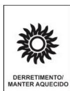
A tecla 2 (NEL ou melting) quando pressionada logo ao ligar a fritadeira, aquece somente até 100 °C e desliga o aquecimento. Quando pressionada estando a fritadeira em uso, ela desligara o aquecimento diminuindo a temperatura para 100 °C. Essa tecla serve para manter aquecido ou derretido o fluido de fritura entre operações. Se não for pressionada ao ligar a fritadeira, a fritadeira aquecera a temperatura ajustada de fabrica (190 °C).
